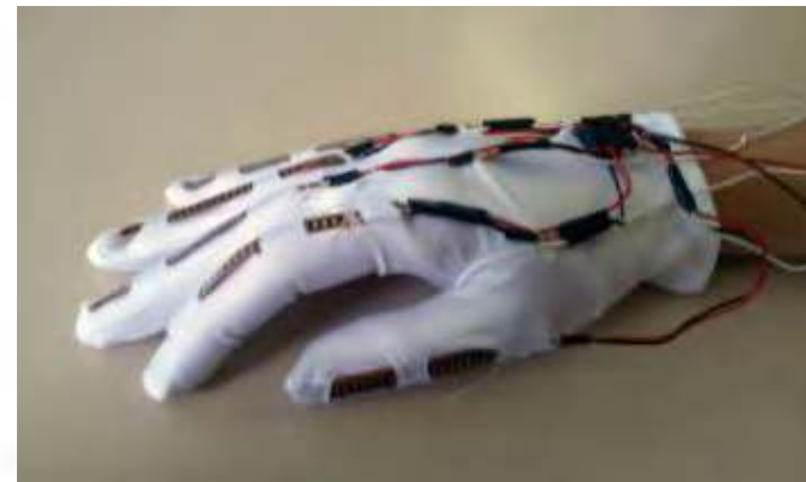
Gant muni de capteurs de flexion
