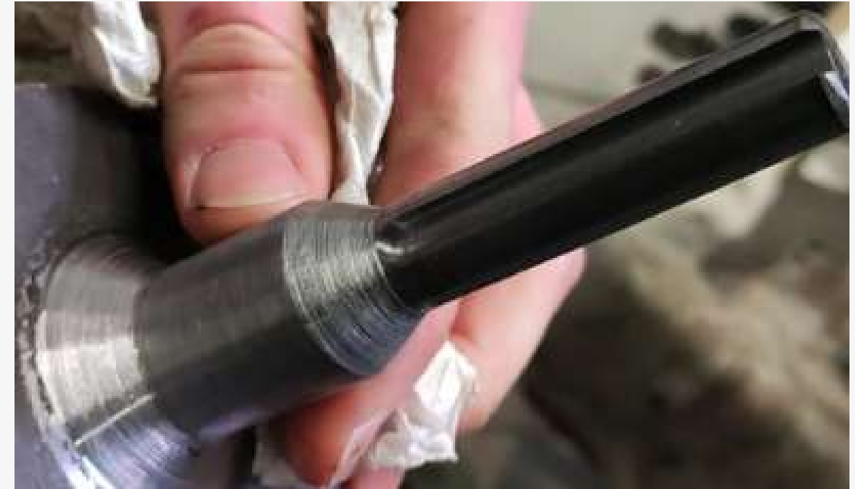
Usinage pour accueillir une clavette
